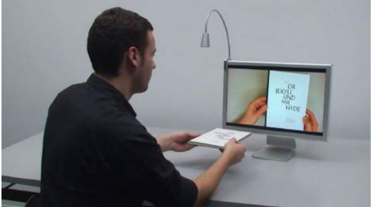
Figura 1. O livro impresso e sua imagem capturada através da câmera posicionada na parte superior do monitor. A partir desse posicionamento é possível manipular o livro físico em frente a câmera e acessar os diversos conteúdos digitais empregados através de RA nas demais páginas do livro. Fonte: http://martinkovacovsky.ch/jekyll-hyde/
