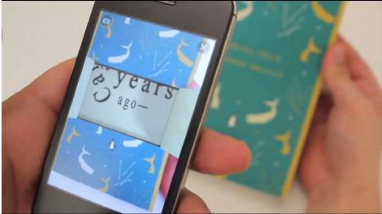
Figura 9. A imagem da capa do livro é capturada e sobreposta a ela duas portas em animação se abrem. Palavras da história pulam na tela em conjunto com a voz de um dublador. Essa aplicação de RA explora basicamente um conteúdo gráfico visual e sonoro desenvolvidos para gerar uma imersão no mundo da narrativa do livro. Fonte: https://www.zappar.com/zaps/moby-dick/
